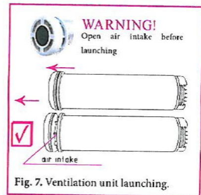
Kuva 6. Yksikön venttiilin aukaisu.
